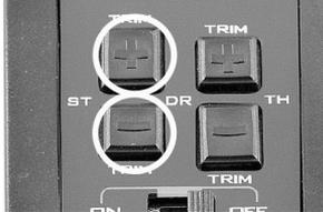
Fahre Dein RC-Modell, ohne das Lenkrad zu benutzen vorsichtig und langsam einer gerade Linie auf dem Boden entlang. Fährst es dabei nicht geradeaus, kannst Du das mit den ST TRIM „+“ und „-“ Tasten korrigieren.
