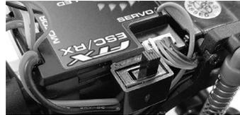
Allumez votre récepteur grâce à l'interrupteur du récepteur/ contrôleur de vitesse situé sous la carrosserie. Comme montré sur la photo.
