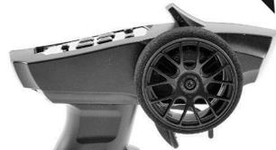
3. Um das RC-Modell nach rechts zu lenken, muss das Lenkrad entsprechend nach rechts gedreht
