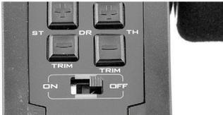
Schiebe dazu den EIN-AUS-Schalter auf seine Position ON und kontrolliere den ordnungsgemäßen Batteriezustand mittels der LED Anzeige.
