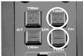
Wenn der Gashebel am RC-Sender sich in seiner Mittel-Neutral-Position befindet, sollte das RC-Modell im Normalfall stillstehen. Macht es dennoch Anstalten, sich vorwärts oder rückwärts in Bewegung setzen zu wollen, kannst Du das mit den TH TRIM „+“ und „-“ Tasten korrigieren, bis es absolut stillsteht.
