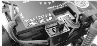
Der EIN-AUS-Schalter befindet sich unter der Karosserie, so wie auf dem Bild zu sehen. Schiebe den EIN-AUS-Schalter auf seine Position ON.
