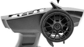
1. Um das RC-Modell geradeaus fahren zu lassen, muss das Lenkrad einfach nur in Mittel-Neutral-Position stehen gelassen werden.
